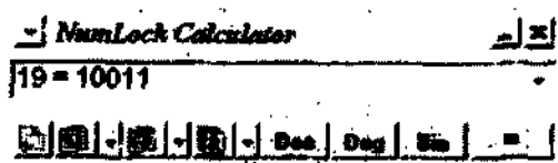
Рис. 2.19. Перевод из десятичной системы счисления в двоичную
