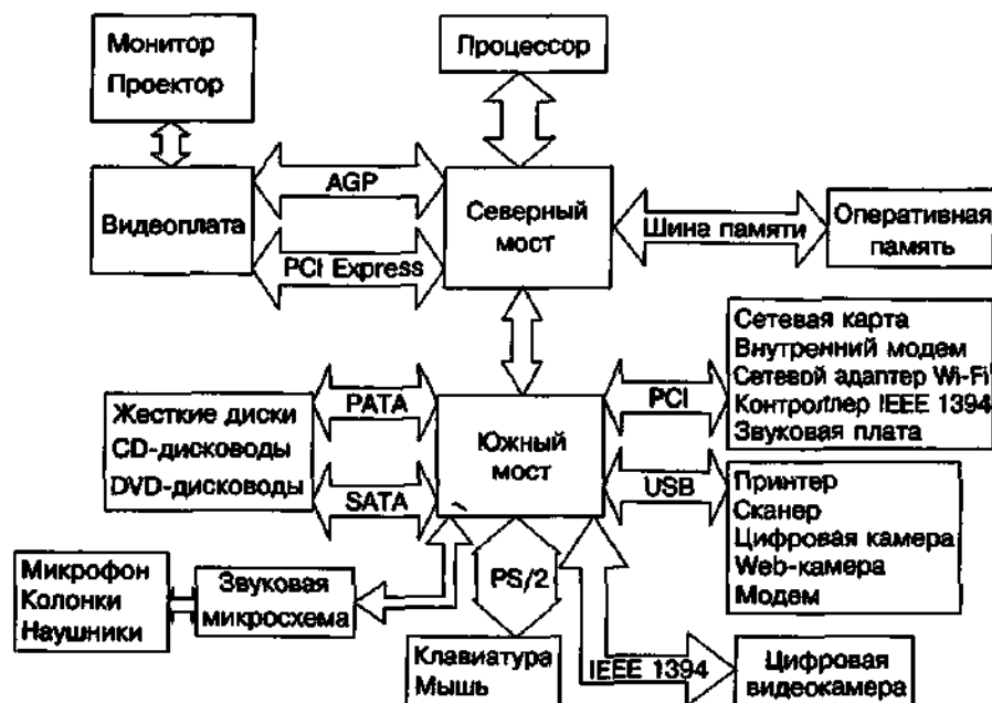
Рис. 1.3. Логическая схема системной платы
